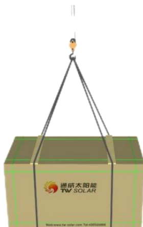
Obrázek 6 Schéma zvedání modulu
